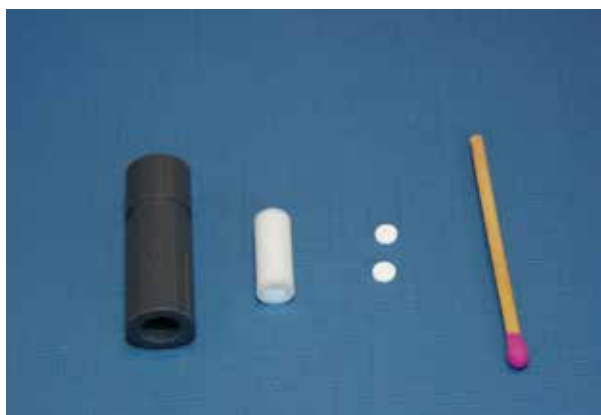
Selbstgefertigte Anreicherungssäule aus 1,5 cm langem Polymethylenzylinder mit Innendurchmesser 2,5 mm, befüllt mit 20 mg C18-Kieselgel und mit 2 selbstgestanzten Fritten verschlossen. Die Anreicherungssäule wird zur Fixierung in eine Kunststoffröhre eingeschoben. (Bild: Dr. Neudorfer-Schwarz, LGL Bayern)
