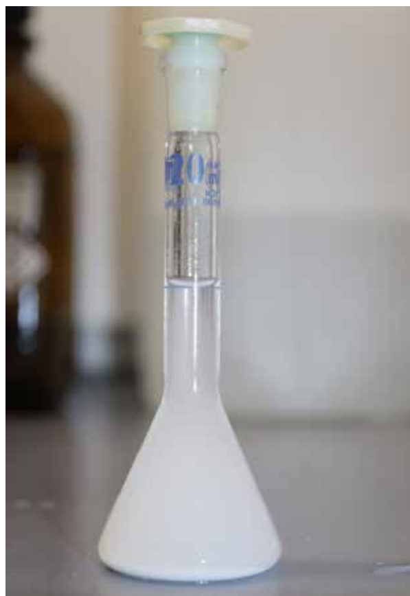
Abb. 2: Aufgefüllte trübe Aufschlusslösung
