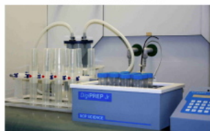
SCP Digiprep Heizblock, 50 ml PE-Gefäße Temperaturmessung in Referenzgefäß parallele Filtriereinheit für Extraktionslösungen
