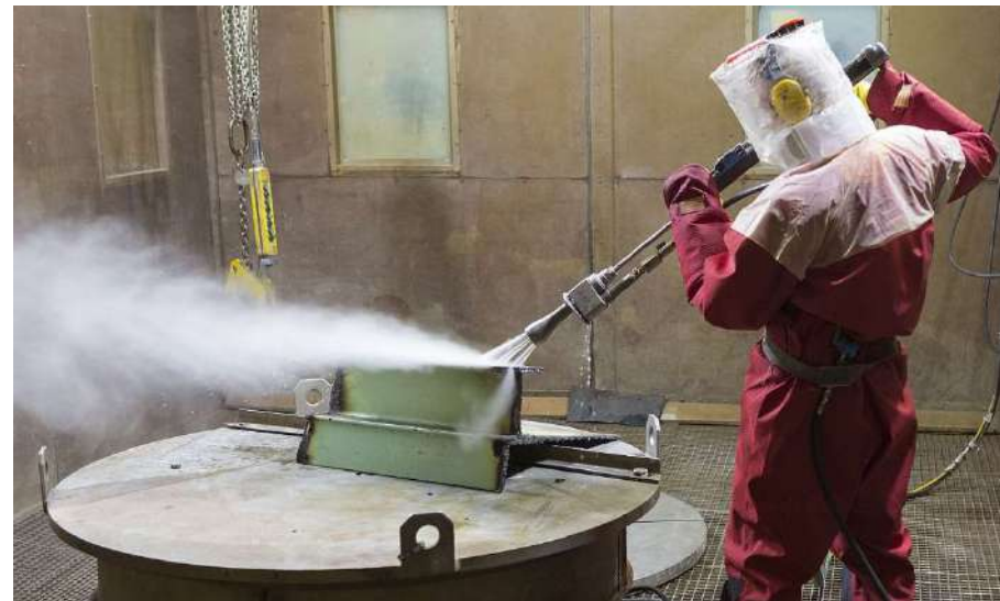
Oberflächen Dekontamination KTE
